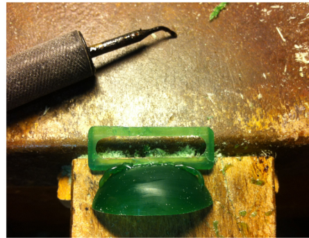
Con el soldador de cera aplicamos textuta y soldamos el tirador.
