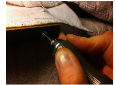
Perforar el marco de la puerta para incrustar los imanes que anclaran las puertas.
