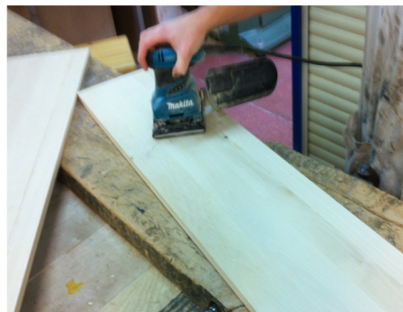
Lijar la superficie variando el grano de la lija de un menor a un mayor grano para dejar un fino.
