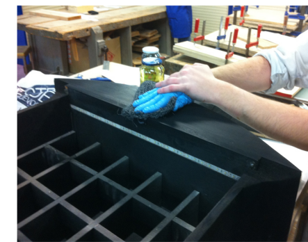
Para cerrar el poro de la madera frotamos la superficie seca del mueble con un guante de esparto.
