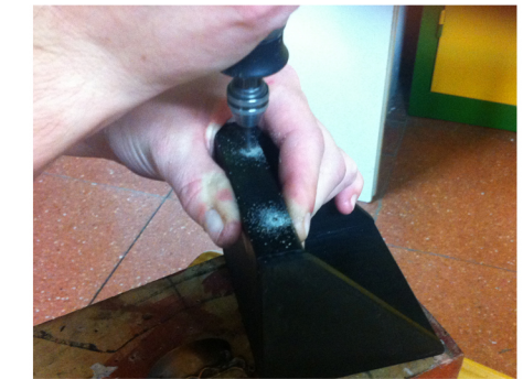
Con la broca perforamos la piel y profundizamos en la madera unos 2mm.
