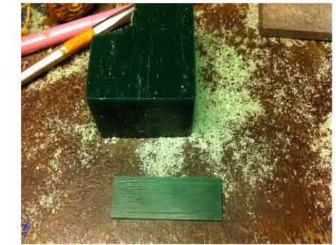
A partir de un bloque de cera de joyeria tallamos el prototipo del tirador de los cajones.
