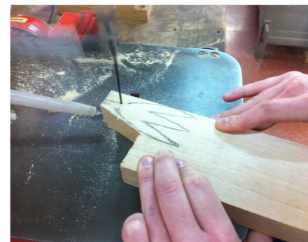
Cortamos las garras de las grullas con un pelo de segueta de 3mm. Ajustamos al igual que lñas grullas el perfil y el frente, eliminando el máximo de material.
