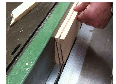
La altura de corte no alcanza la longitud de la tabla, asi que los últimos milímetros se cortan en otra tanda.
