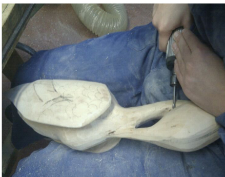
Con precisión ajustamos las partes delicadas de la talla con una fresa pequeña y con ayuda de gubias.
