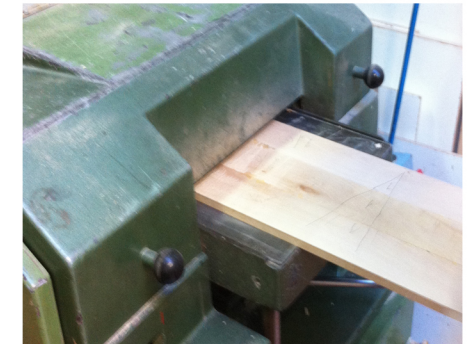
Regruesar la tabla para obtener el espesor deseado.
