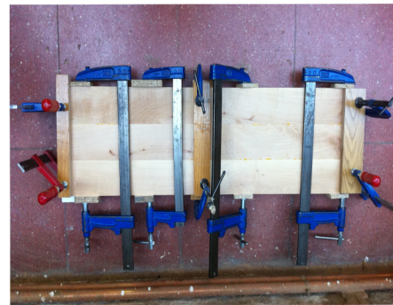
Agarrar la superficie encolada con gatos y listoncillos para evitar que se comben las tablas.
