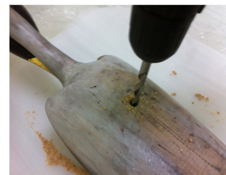
Con una broca del 8 hacemos 2 taladros sobre la superficie trasera de la grulla, introducimos el perno de madera que unirá la grulla con el armario.
