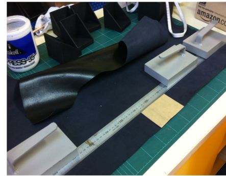
Tras el secado de los cajones frotamos las piezas con un guante de crin (para eliminar el repelo de la madera) y cortamos las pieles de las bases.
