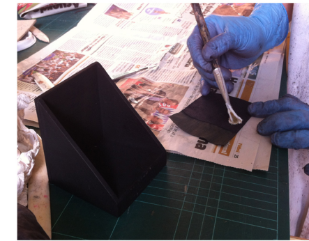
Aplicamos cola "Rakol" sobre la superficie a pegar de la piel y con ayuda de una plegadera presionamos para adherir sobre la superficie de madera.
