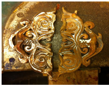
Una vez fundidas las piezas cortamos los bebederos, y lijamos.
