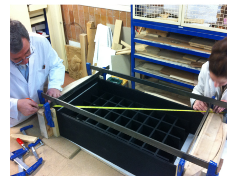
Al encolar los laterales medimos repetidas veces, las diagonales para conseguir un ángulo de 90º.
