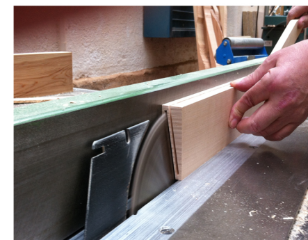
Cortar las cuñas de la base de los cajones, en la sierra de mesa con un ángulo de 8,5 grados.
