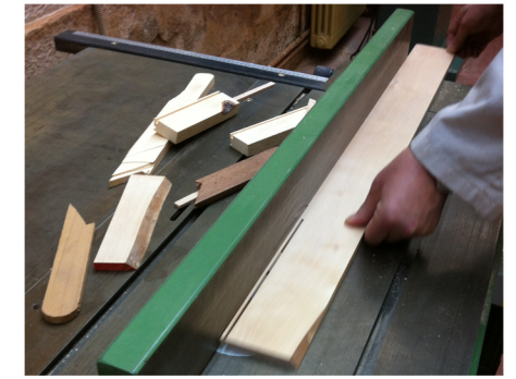
Sacar listoncillos para ensamblar los listones grandes introduciendolos por un carril a mitad de estos.
