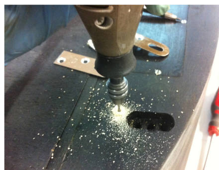
Para colocar los anclajes donde irá la escarpia utilizaremos una broca de pala de 15mm. y despues con una broca de 2mm taladraremos para fijar los tornillos
