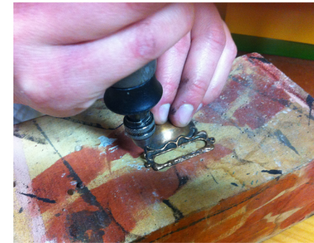
Después de patinar las piezas con el soplete y sulfuro de potasio, abrimos los agujeros que hayan cerrado durante la fundición para luego insertar los clavos.
