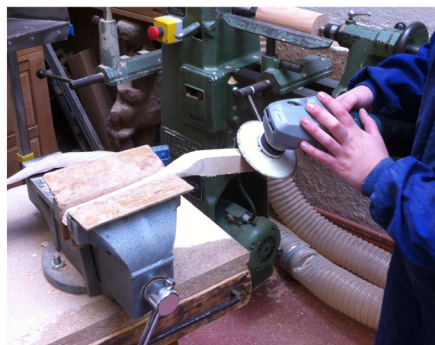
Tras cortar el perfil de las patas con la sierra de cinta de 3,5 cm, desbastamos la madera con la lijadora radial.
