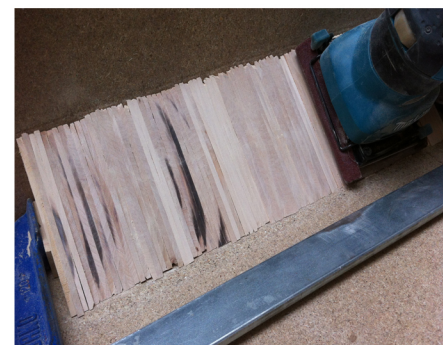
Juntar todos los laterales con un garo y lijar los cantos para igualar las tablitas.
