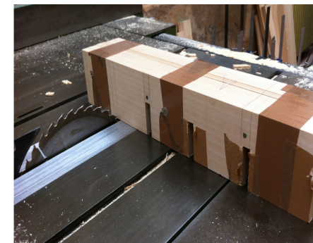
Marcar las zonas de corte y protegerlas con celo, para evitar que se astille. Regular el disco con la profundidad de corte deseada.
