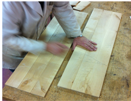
Para eliminar las tensiones contrapear los listones.
