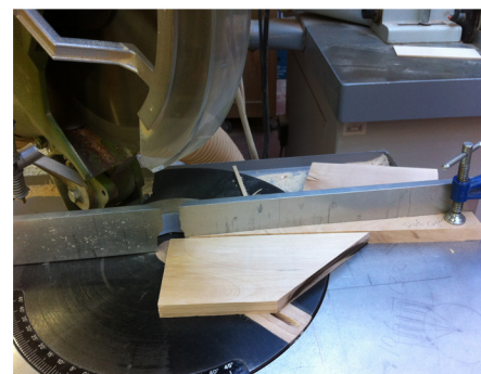
Como la ingletadora no alcanza el ángulo deseado se crea un ángulo de apoyo para cortar los laterales.
