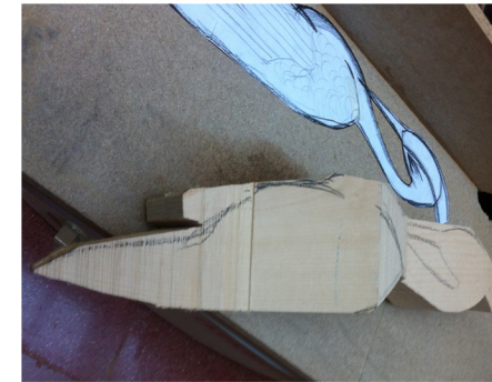
Una vez eliminado el máximo de material con la sierra, dibujamos el alzado y perfil para empezar a tallar.
