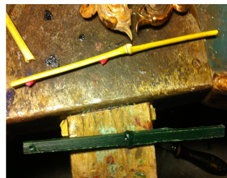
Reproducimos en cera el palillo de bambú que hemos utilizado durante el proceso.
