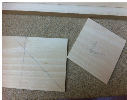
Trazar diagonal sobre tabla lateral para averiguar el ángulo de corte de la base en relación con la altura y profundidad.
