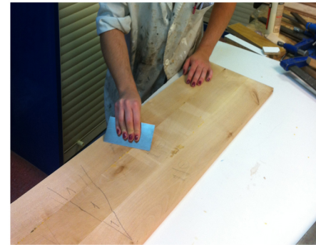
Una vez seco eliminar los restos de cola y comprobar su se ha convado la tabla.
