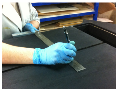
En la trasera marcamos los puntos a taladrar, que fijaran la estructura modular de cuadrados a la trasera y laterales del mueble.
