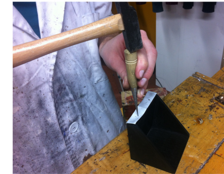
Con una plantilla marcamos el cajón con un punzón para saber donde taladrar, para guiar al clavo y no dañar la piel.
