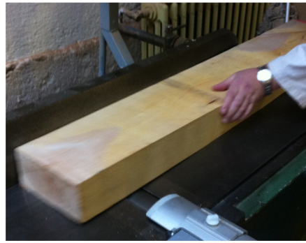
Cepillar la viga creando un ángulo recto para mas tarde gregruesarla.
