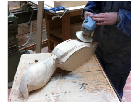
Con la radial eliminamos las zonas mas salientes de la talla dejandola preparada para trabajar zonas delicadas con el motor de mano y las fresas.
