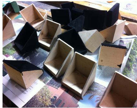
Para el acabado negro, realizamos un ebanizado con cloruro de anilina y ácido crómico.
