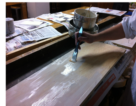
Con una brocha de pelo sintético suave, aplicamos varias manos de aparejo caliente sobre las puertas, respetando los tiempos de secado.
