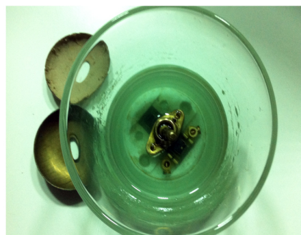
Antes de instalar el interruptor, limpiar el interior ( pieza antigua) con alcohol y dejar evaporar.
