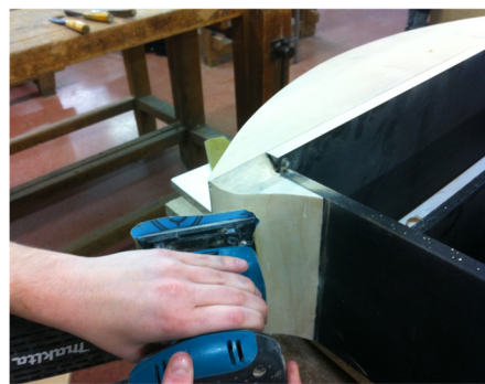
Por último lijamos la superficie eliminando las marcas de la gubia.
