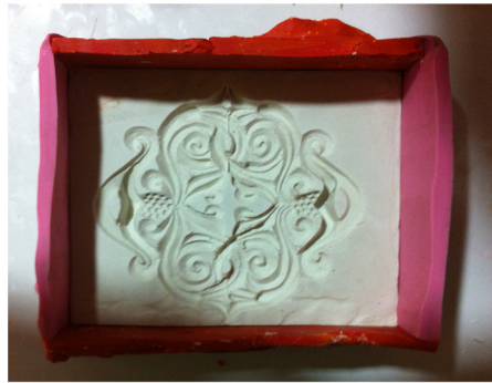
Una vez seca la escayola retiramos la plastilina y repasamos los huecos dejando saliza para el positivo.
