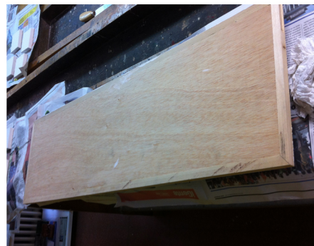
Para aliviar las tensiones del aparejo sobre la madera he utilizado contrachapado de 15 mm. Canteado con madera de abedul.
