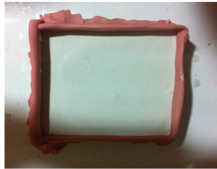
Aplicamos desmoldeante en el negativo y vertemos la escayola, comprobamos que la muestra positiva está bien.
