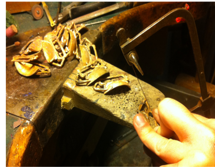
Tras obtener el prototipo, sacamos un caucho para realizar el resto de reproducciones. Una vez fundidas eliminamos los bebederos.
