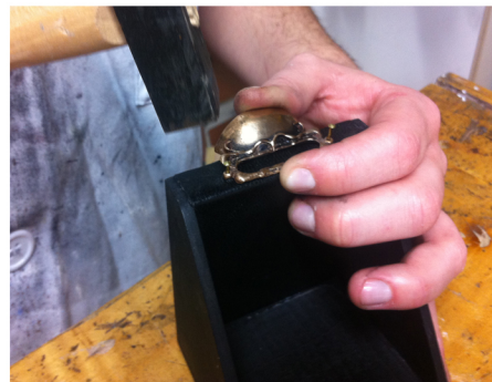
Fijar con clavos los tiradores de bronce y encerar el cajón.
